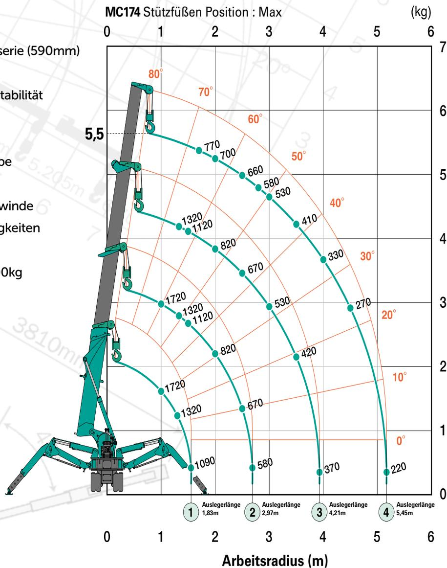
Das Arbeitsbereich-Diagramm zeigt die Gesamtnennlast einschließlich der Reichweite des Auslegers.
